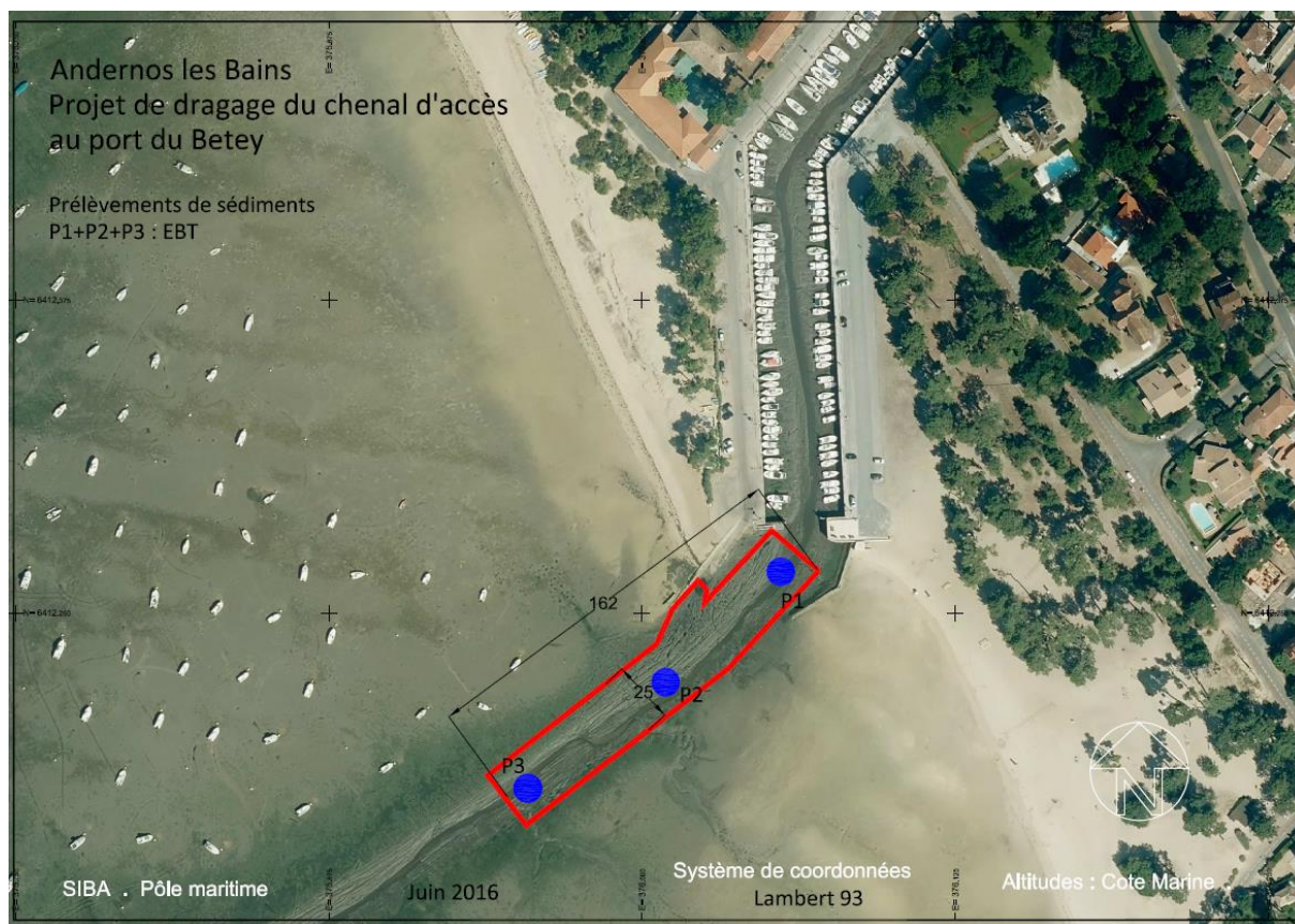
Figure 8 : Plan d'échantillonnage des sédiments du chenal du Betey, septembre 2017
