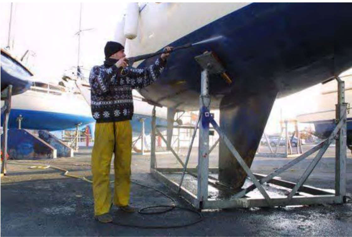
Nettoyage des coques à la brosse et au karcher
